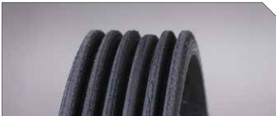
**Aspetto:** L'usura è più grave su una nervatura rispetto alle altre oppure una nervatura presenta una diversa tipologia di usura rispetto alle altre. Inoltre è possibile udire un rumore stridulo o martellante.
