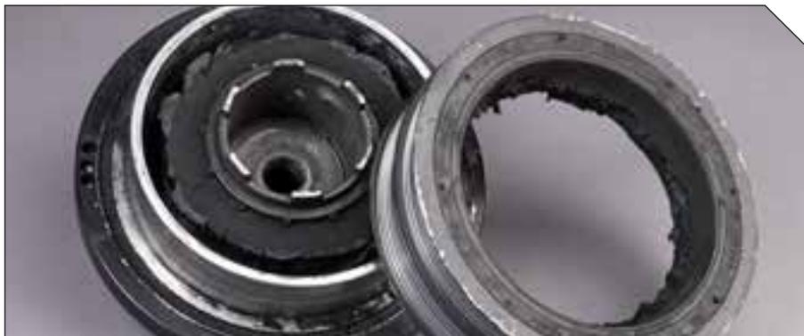
**Aspetto:** Le pulegge smorzatrici si staccano fisicamente. Può inoltre staccarsi completamente dal motore comportando un'immediata rottura e danni collaterali.
