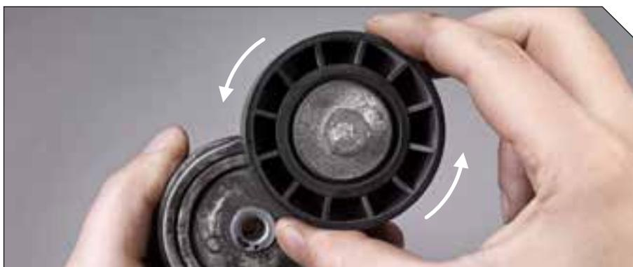
**Aspetto:** A motore spento e cinghia rimossa, ruotare manualmente la puleggia. Se si nota un rumore, resistenza o ruvidità, il problema probabilmente è l'usura del cuscinetto della puleggia.
