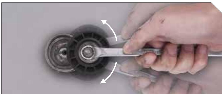
**Aspetto:** Eseguire il ciclo del tenditore (montato sul motore) attraverso l'intera gamma di movimento (da un arresto all'altro applicando coppia al braccio con una chiave. Il braccio del tenditore deve spostarsi scorrevolmente e liberamente.
