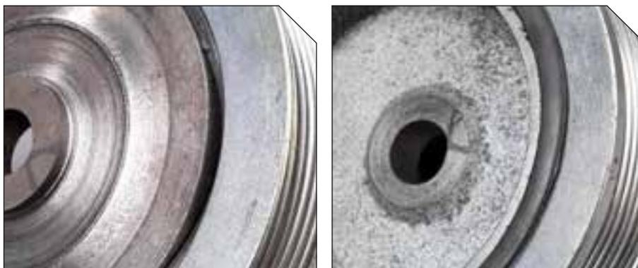
**Aspetto:** L'anello del materiale elastomerico è chiaramente deformato. La deformazione inizialmente diventa visibile sul retro degli ammortizzatori. Questo tipo di danno è frequentemente sottovalutato nelle ispezioni perché la puleggia stessa spesso non viene rimossa per l'ispezione visiva e viene esaminata solo la parte frontale.
